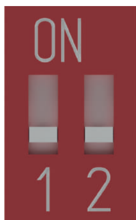
Рисунок 6.8.2 Dip-переключатели, расположенные на плате считывателя
