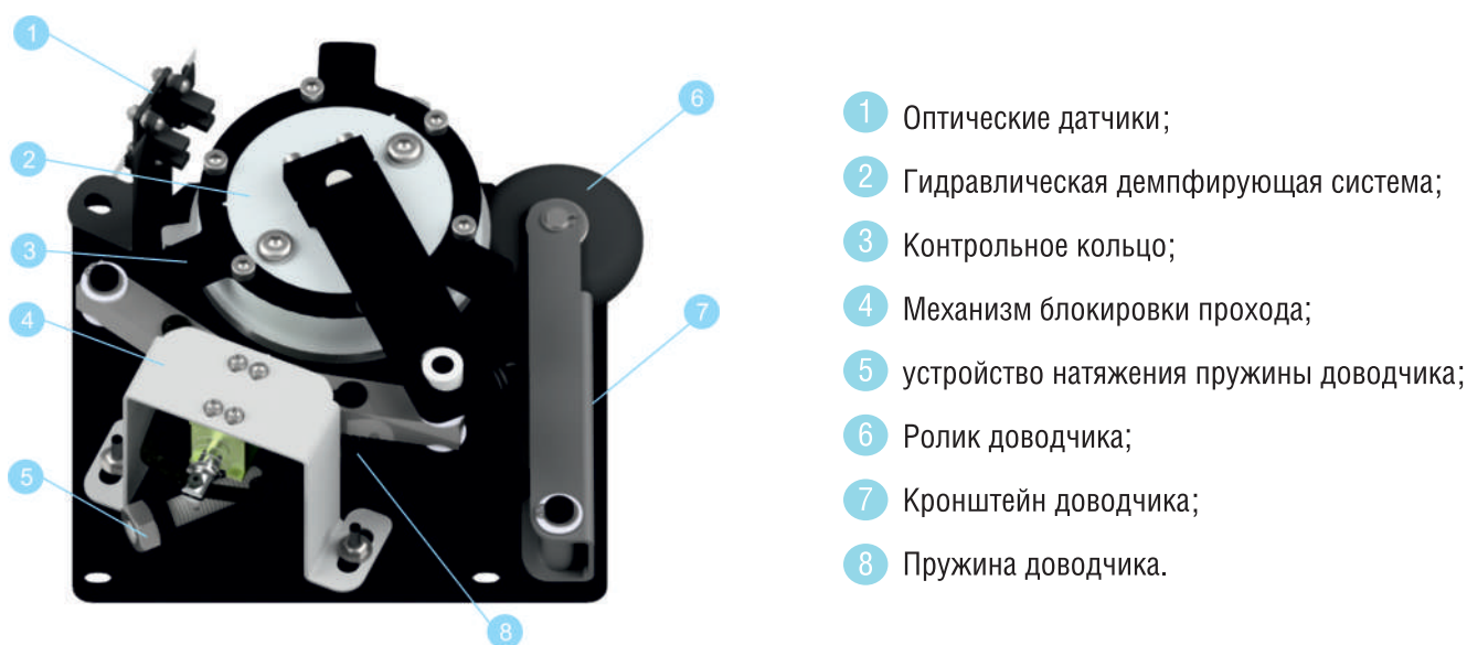
Рисунок 6.2.1 Устройство механизма турникета
