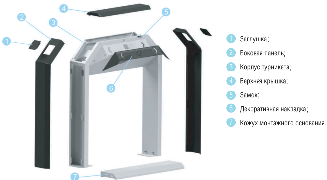
Рисунок 6.1.1 Элементы корпуса турникета «STR-03EW»
